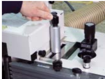
2 Angenehm dimensioniert: Griffige Klemmhebel, Stern- und Rändelschrauben
