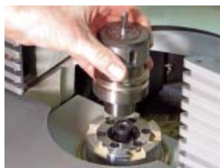
13 HSK-Schnittstelle ist ein hoch präzises System: Sauberkeit ist Pflicht!
