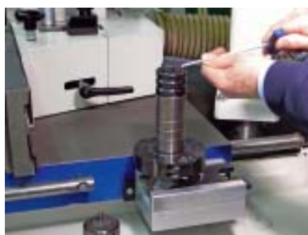
12 ... und große Werkzeuge mit HSK-63-Schnittstelle gleichermaßen gut
