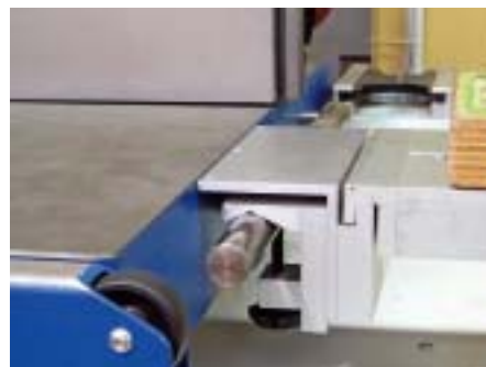
8 Geht doch: Ein Adapter ermöglicht den Anbau der Aigner-Tischverlängerungen
