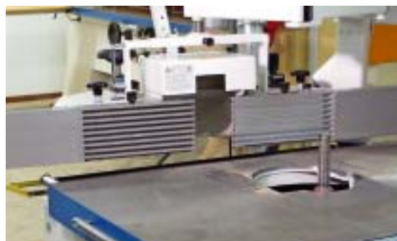
4 ... dann noch hochkurbeln und wegschwenken: Der freie Frästisch steht zur Verfügung
