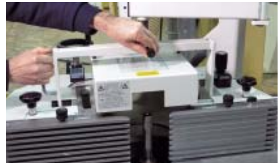
3 Einarbeitung erforderlich: Positionieren und Andocken der Hebebrücke für 70-kg-Anschlag ...
