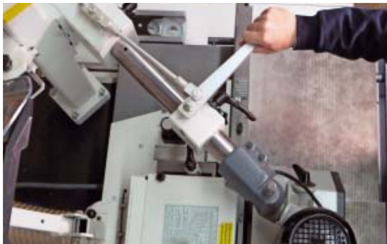
16 Trickig: Statt mit (schwergängiger) Handkurbel wird der Vorschubausleger per Hebel verschoben
