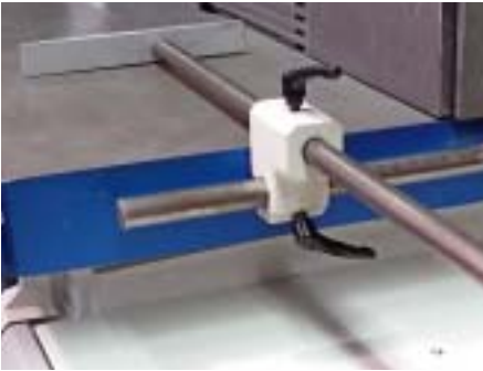
9 Rückschlagsicherung: Für kurze Teile praktisch, bei langen stört der Knoten
